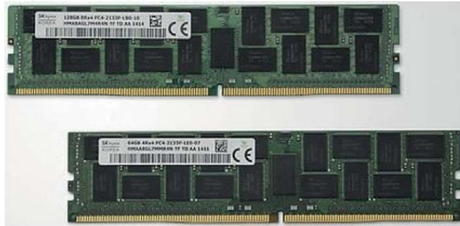
Abb. 2–20 DDR-DIMMs gibt es mit Kapazitäten von 2 bis 32 GByte.
