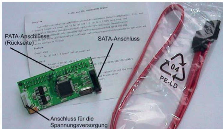
Abb. 13–2 Ein separater PATA-auf-SATA-Umsetzer
