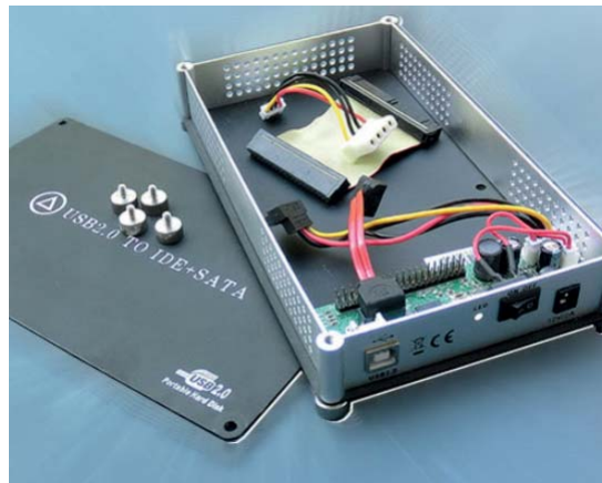
Abb. 13–1 Hier lassen sich sowohl SATA- als auch IDE-Festplatten einbauen.
