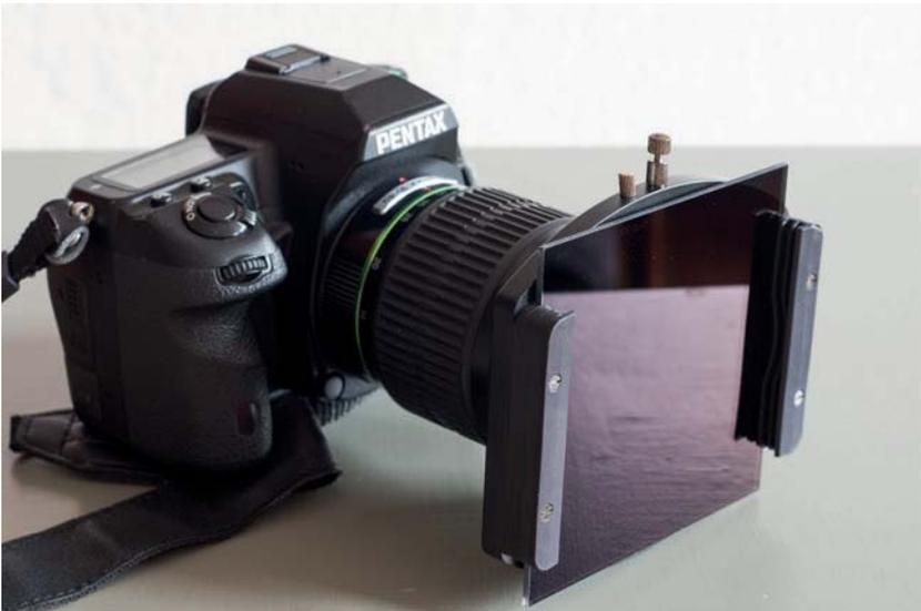
*Aufgesetzter Steckfilterhalter von Rollei mit eingestecktem ND-Filter*
