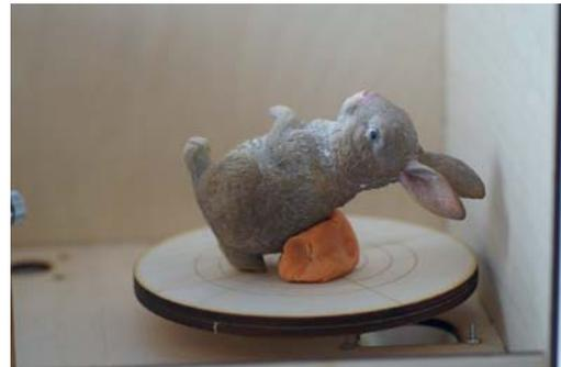
*Objekt in zweiter Scan-Position für einen weiteren Scan-Durchgang mit Knete in seitlicher Lage fixiert*
