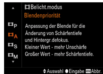
Abbildung 15.7: Wie in den Foto-Kreativprogrammen stehen Ihnen auch im Filmmodus die Programme »P«, »A«, »S« und »M« zur Verfügung.
