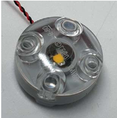
Abb. 10-149 PicoLED von Brickstuff in Scheinwerferkonstruktion
