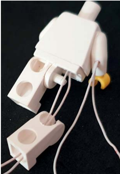
Abb. 8-78 Kabeldurchführung im Bein
