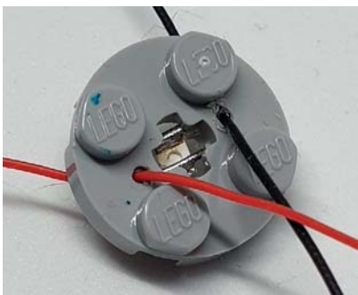
Abb. 10-150 Bohrungen und durchgeführte Kabel
