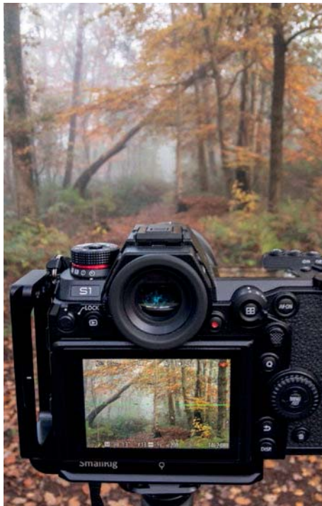
Eine spiegellose Vollformatkamera mit L-Bracket, um bequemer im Hochformat fotografieren zu können. | Ellen Borggreve
