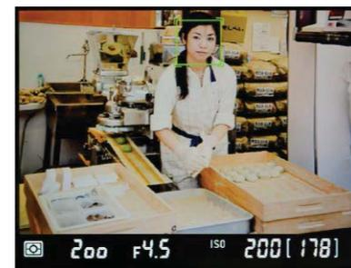
Bei der Einstellung AF-S wird jedoch nur das Fokusfeld verschoben, die Fokussierung selbst erfolgt erst, wenn Sie den Auslöser halb herunterdrücken. Bedenken Sie dabei, dass die Fokussierung beim
