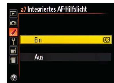
⌘ *Um bei Dunkelheit das Motiv zum Fokussieren zu beleuchten, hat die Nikon D610 ein INTEGRIERTES AF-HILFSLICHT. Über die Individualfunktion a7 können Sie es ausschalten. Es leuchtet generell nur im AF-S-Modus bei Auswahl des mittleren Fokusfeldes.*
