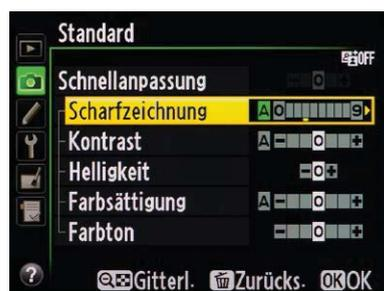
Für die Stärke der Scharfzeichnung stehen die Werte 0 bis 9 und eine Automatik zur Verfügung.
