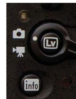
Der Kontrast-Autofokus verhält sich im Foto- und Videomodus gleich. Jedoch ändern sich im Videomodus die Tastenbelegungen der Funktions-, Abblend- und AE-L/AF-L-Tasten.
