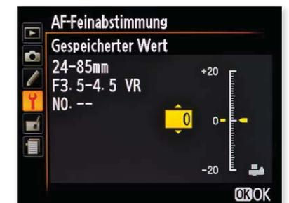
» Mit der AF-FEINABSTIMMUNG können Sie den Phasen-Autofokus für jedes Objektiv speziell anpassen.
