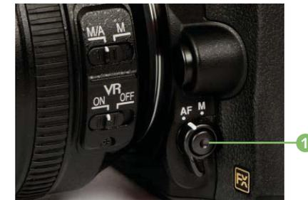
» Über den Knopf 1 im AF-Schalter verstellen Sie den Autofokusmodus und die Messfeldsteuerung.
