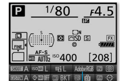
Drücken Sie die info-Taste, können Sie im unteren Bereich der Anzeige die kamerainterne Farbraumeinstellung ablesen 1.
