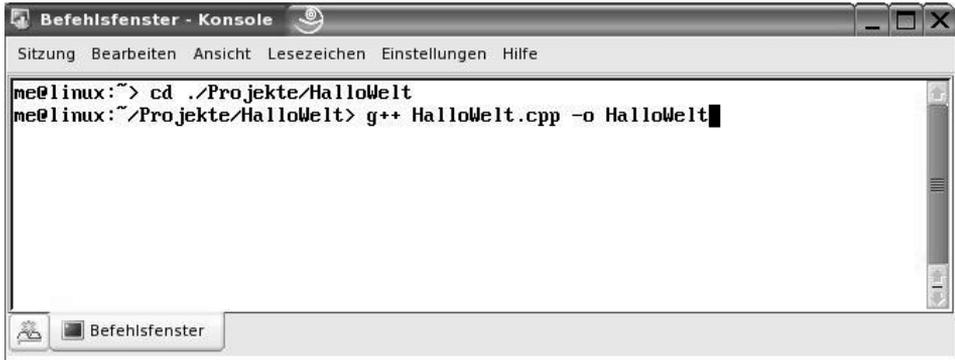
**Bild 2.8** Kompilation und Erstellung einer ausführbaren Datei
