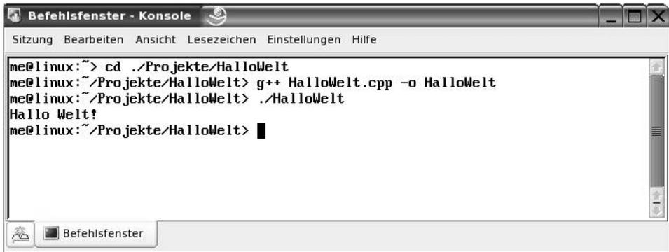
**Bild 2.9** Ausführung von Konsole
