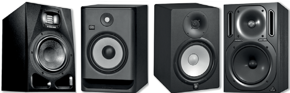
Abb. 1.2: Einige erschwingliche 2-Wege-Nahfeldmonitore mit Reflexöffnungen (von links nach rechts): Die ADAM A7X haben zwei kreisförmige Reflexrohre an jeder Seite des Tieftöners; die KRK Rokkit 8 haben eine Reflexöffnung unterhalb des Tieftöners; die Behringer 2030A haben zwei schmale Reflexöffnungen auf jeder Seite des Hochtöners und die M-Audio DSM2 beherbergen eine einzelne Reflexöffnung auf der Rückseite.
