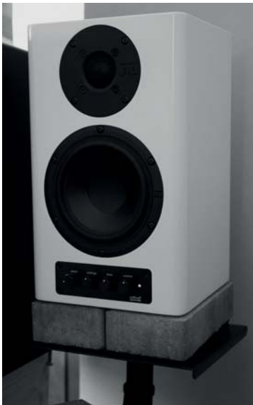
Abb. 1.6: Die Recoil Stabilizer von Primacoustic nehmen sich auf geschickte Weise einer Vielzahl der Probleme von Abhöranlagen in kleinen Studios zugleich an: Die gummierte obere Matte hält den Lautsprecher fest und fixiert ihn auf einer schweren Metallplatte und erhöht so die Trägheit, während die Schaumstoffunterlage den Lautsprecher hinsichtlich Körperschall vom Untergrund entkoppelt.
