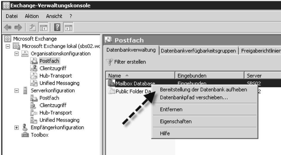
Abbildung 4.5 Vor der Bearbeitung von Datenbankdateien mit Eseutil müssen Sie die Bereitstellung aufheben
