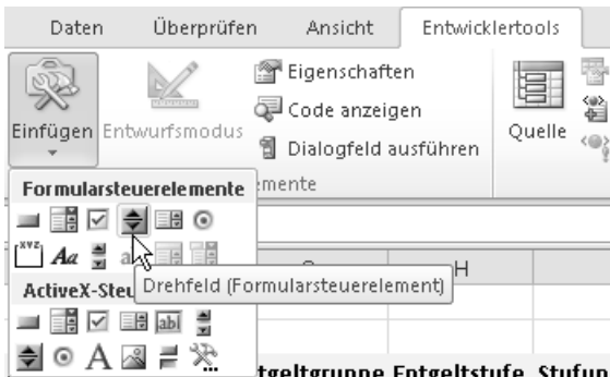
Abbildung 4.43 Die Formularsteuerelemente finden Sie auf der Registerkarte Entwicklertools unter dem Symbol Einfügen . Es stellt die gängigen Steuerelemente bereit
