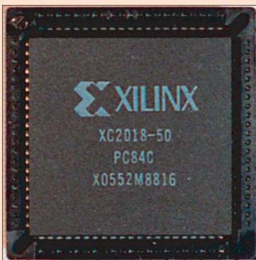
**Abbildung 1.2** XC2018 – der zweite FPGA von Xilinx
