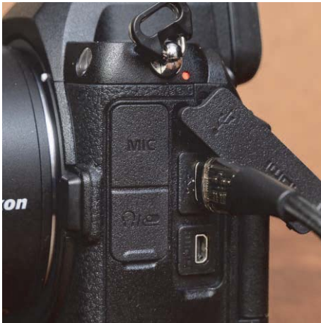
Abbildung 1.4 Über den USB-C-Anschluss können Sie die Kamera mit Strom versorgen und den Akku laden. Etwas darüber sehen Sie die mit CHG markierte LED.
