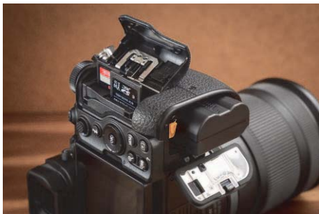
Abbildung 1.3 Das Speicherkartenschacht wird seitlich geöffnet, den Akku setzen Sie von unten ein. Achten Sie darauf, dass die orangefarbene Akkusicherung einrastet.
