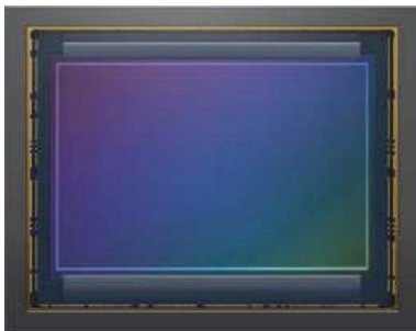
Abbildung 4.6 Der CMOS-Sensor ist das zentrale Element Ihrer Kamera. (Bild: Sony)
