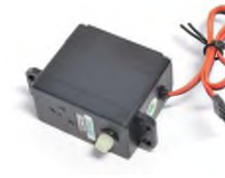
Abbildung 6.62 Ein handelsüblicher Modellbauservo von Adafruit
