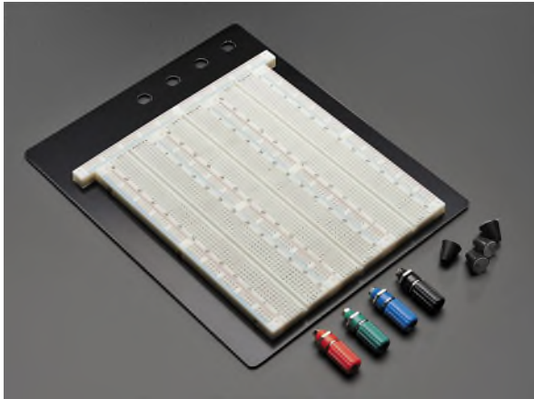
Abbildung 1.46 Die große Variante des Steckbretts von Adafruit für 19 EUR
