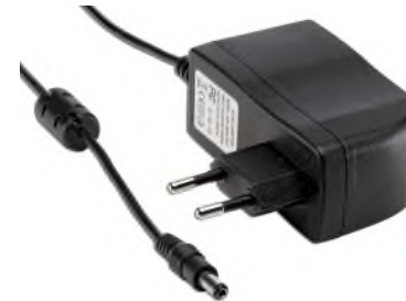
Abbildung 1.41 Ein 12-V-Steckernetzteil eines alten Routers
