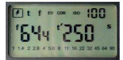
⤴ Das Canon Speedlite 600EX-RT lieferte ausreichend Licht, um theoretisch mit 1/250s bei ISO 100 mit Blende f64,4 fotografieren zu können.
