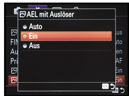
▼ Abbildung 10.20 Mit dieser Einstellung wird die Bildhelligkeit beim Drücken des Auslösers fixiert.
