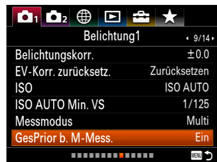
Abbildung 3.9 > Bei der Multi-Messung werden erkannte Gesichter besonders in die Belichtungsmessung einbezogen, wenn Sie die GesPrior b. M-Mess. einschalten.
