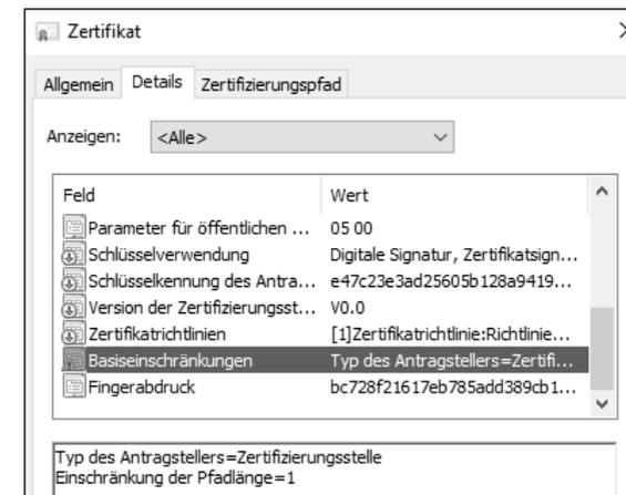
Abbildung 2.45 Auswirkung der konfigurierten Basis Einschränkung
