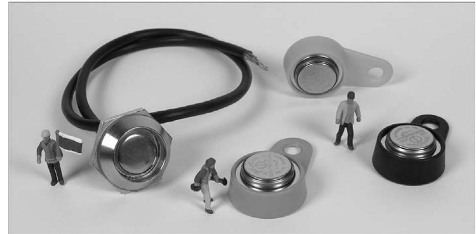
Abbildung 3.6 iButtons mit Ausleseseinheit
