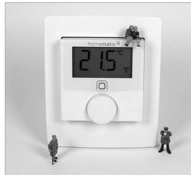
Abbildung 27.9 Raumregler im Tischgehäuse für die Handbedienung
