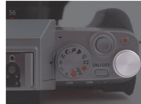
Abbildung 3.17 Das hintere Einstellrad dient in fast allen Programmmodi der Belichtungskorrektur.
