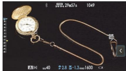
**Abbildung 3.22** Ein blaues Symbol oberhalb der Belichtungsskala bzw. dem Belichtungswert als Ziffer (wenn eingeblendet) zeigt auf dem Display bzw. im Sucher zusätzlich das entsprechende Einstellrad an.
