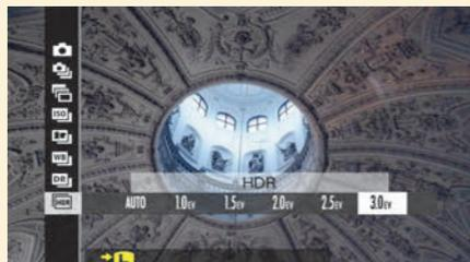
**Abbildung 3.34** Die HDR-Funktion der X-T200 übernimmt die komplette Arbeit, eine perfekte Belichtungsreihe zu erstellen. Als Ergebnis erhalten Sie ein JPEG-Bild.
