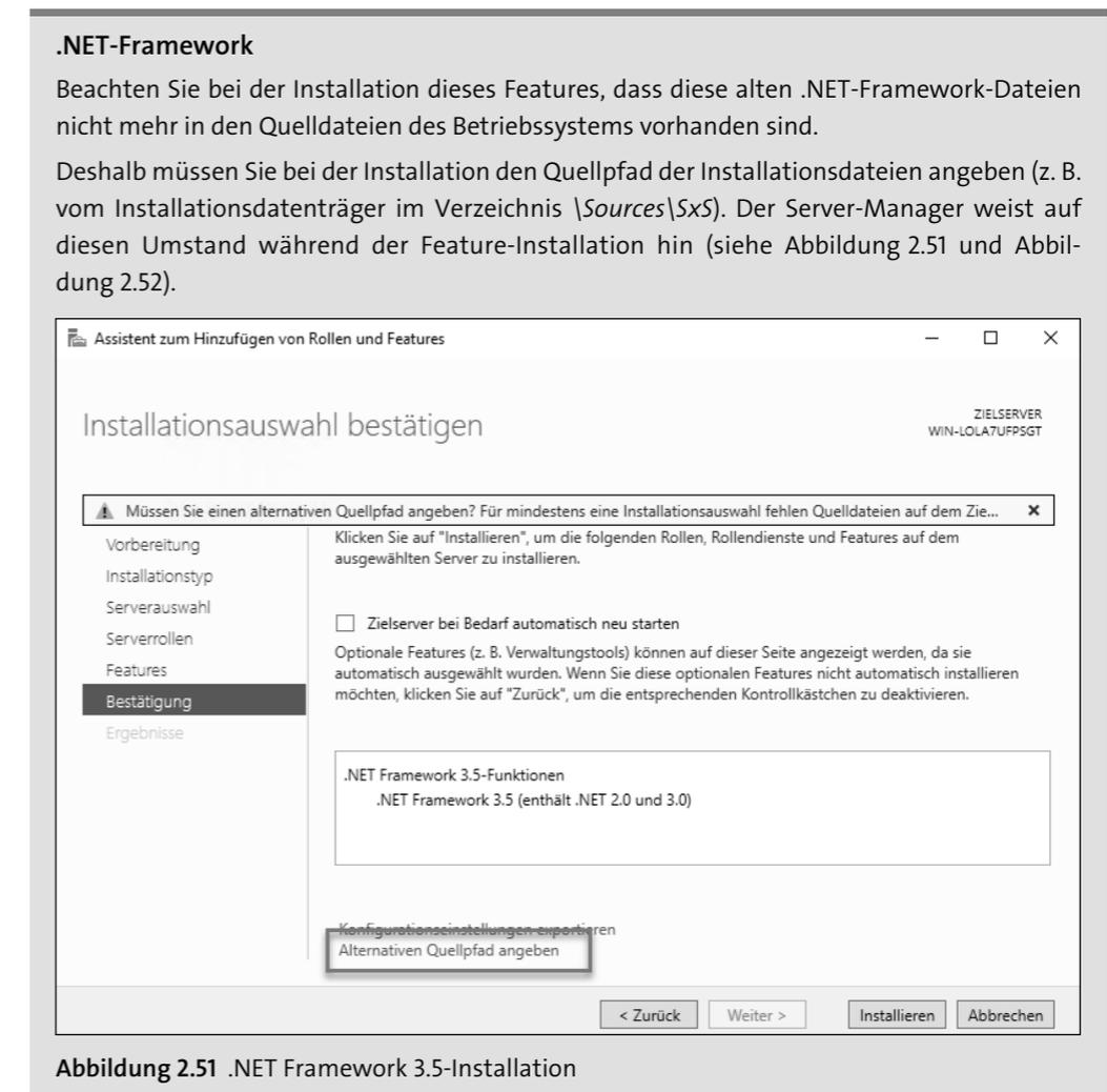
Abbildung 2.51 .NET Framework 3.5-Installation
