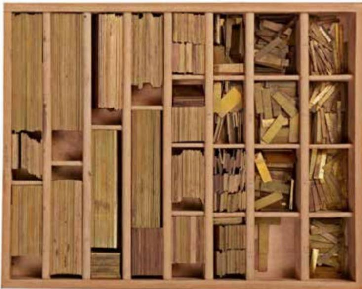
**Liniensystem** – es gibt Linien von 1 p fein, das entspricht 0,075 mm, bis 48 p. Bei feinen und stumpffeinen Linienbildern (Druckbild) sind die Linienkörper (Kegel) 1 oder 2 Punkt stark, bei 2 p fetten Linien ist das Linienbild 1 p.
