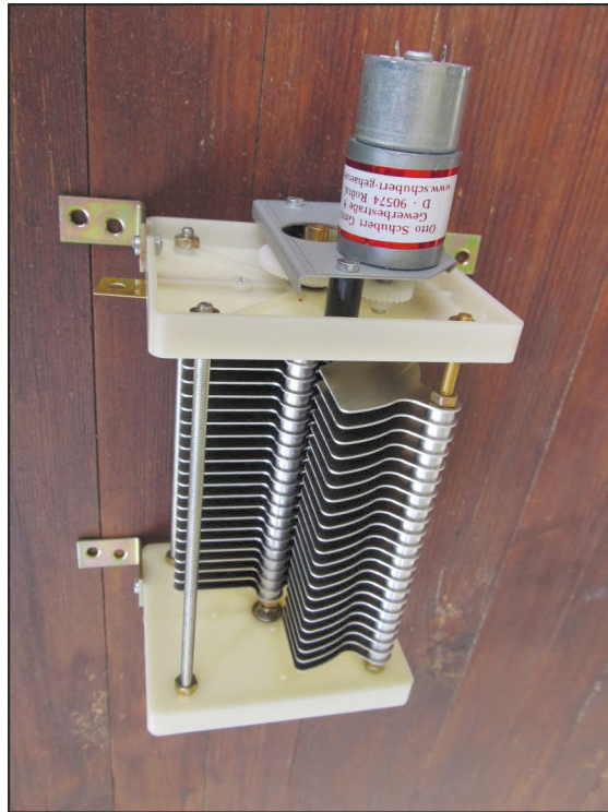
Abbildung 29.13 Fertig aufgebauter Drehkondensator mit Motor für die Fernabstimmung
