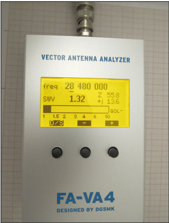
Abbildung 29.9 Einzelmessung mit Antennenanalysator
