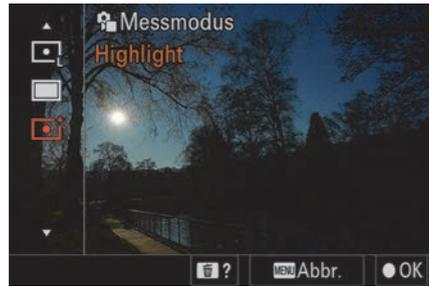
Abbildung 3.21 Die Messmethode **Highlight** führt bei Gegenlicht zu einer deutlichen Unterbelichtung.
