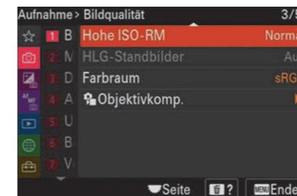
**Abbildung 3.14** Die Rauschunterdrückung für JPEG-Aufnahmen bei hohen ISO-Werten ist standardmäßig aktiv.
