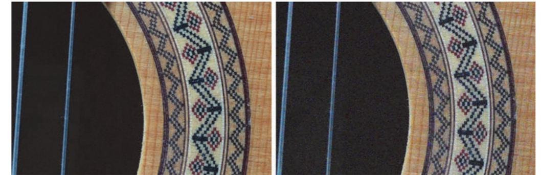
**Abbildung 3.13** ISO-Werte 1.600 (links) und 51.200 (rechts) ohne Rauschunterdrückung im Vergleich (Bildausschnitt)
