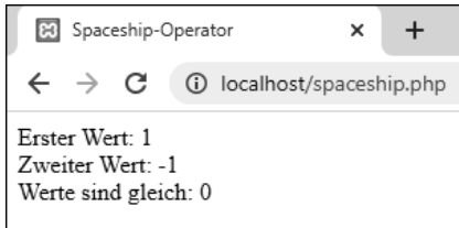
Abbildung 1.41 Auswertung mithilfe des Spaceship-Operators <=>
