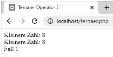
Abbildung 1.40 Verzweigungen mit dem ternären Operator »?:«
