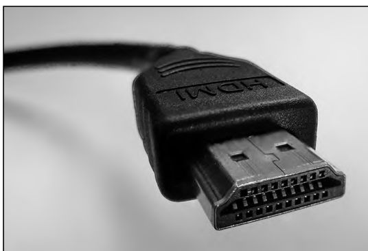
Abbildung 1.13: HDMI hat die alten VGA- und DVI-D-Adapter weitgehend abgelöst.
