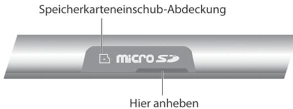
**Abbildung 1.2:** Den Speicherkarteneinschub öffnen
