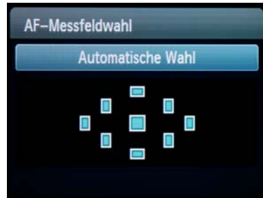
AF-Messfeldwahl an einer Canon-SLR: Die Kamera wählt automatisch die Fokussfelder aus, mit denen scharfgestellt wird
