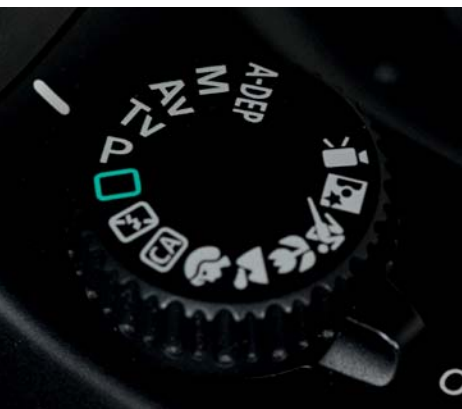
Links: Programmwahlrad bei einer Canon-Kamera. Av und Tv heißen bei den meisten anderen Herstellern A und S. Rechts: Programmwahlrad an einer Nikon-Kamera
