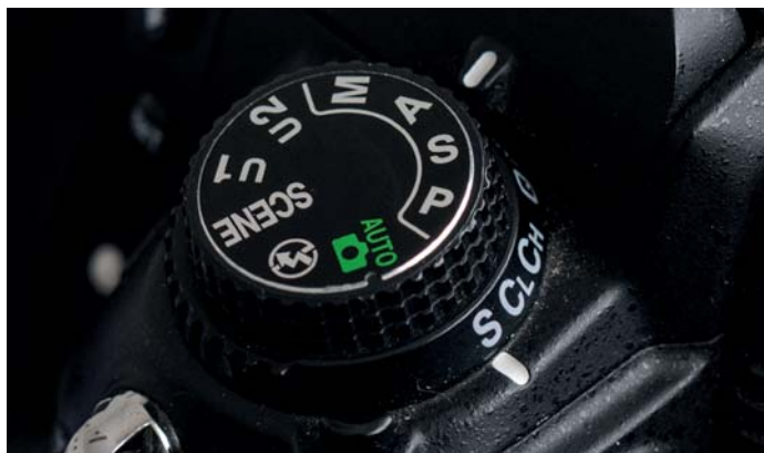
Links: Programmwahlrad bei einer Canon-Kamera. Av und Tv heißen bei den meisten anderen Herstellern A und S. Rechts: Programmwahlrad an einer Nikon-Kamera
