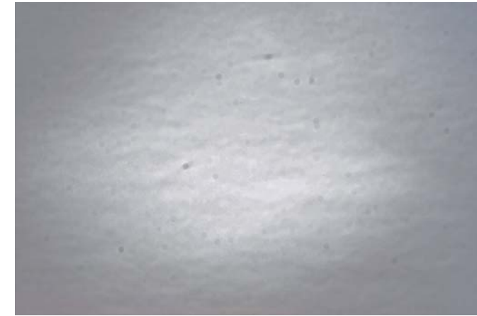
Abbildung 26: Staubflecken auf dem Sensor sichtbar gemacht: Dieser Sensor braucht dringend eine Reinigung.
