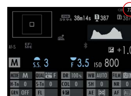
Abbildung 14: Die INFO-Anzeige von X-Kameras mit X-Processor Pro oder X-Processor 4 verfügt über eine prozentgenaue Batterierestzeitanzeige. Mit der DISP/BACK-Taste können Sie auf die INFO-Anzeige zugreifen.
