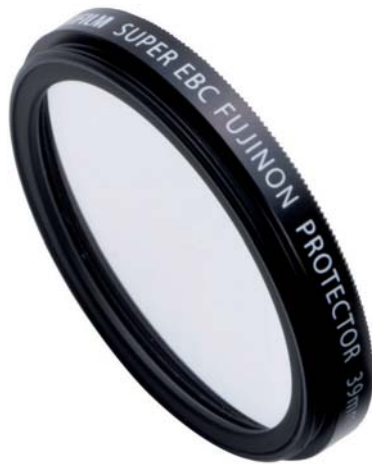
Abbildung 58: Ein 39-mm-Schutzfilter (mit oder ohne Glas) kann als Abstandshalter zwischen dem Objektiv (XF60mm oder XF27mm) und einem Step-up-Ring verwendet werden.
