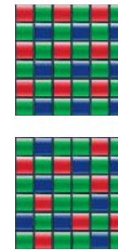
Abbildung 12: Bayer vs. X-Trans: Die meisten Kameras verwenden Bayer-Sensoren mit einer einfachen, repetitiven 2 \times 2 -Farbmatrix, die aus zwei grünen, einem blauen und einem roten Pixel besteht (oben). Fujifilms proprietäre X-Trans-Sensormatrix (unten) basiert auf einem komplexeren 6 \times 6 -Muster, das Moiré auch ohne Tiefpassfilter deutlich reduziert.
