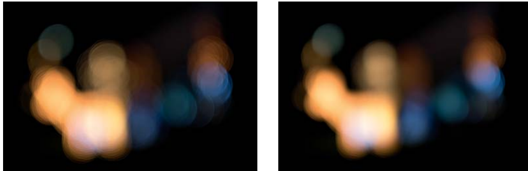
Abbildung 41: Um den Unterschied zwischen einem normalen 56-mm-Objektiv und einem Objektiv mit eingebautem Apodisationsfilter zu verstehen, nimmt man am besten ein Bild auf, das nur aus Unschärfe besteht. Das Bild links zeigt, wie ein solches Szenario mit einem normalen 56-mm-Objektiv bei f/1.2 aussieht. Das rechte Bild zeigt dasselbe Motiv, jedoch mit der APD-Version aufgenommen, und veranschaulicht, wie der Apodisationsfilter die Ränder der Unschärfescheiben glättet.
