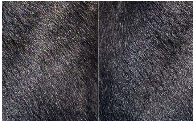
Abbildung 13: Der Einsatz von Bayer-Sensoren ohne Tiefpassfilter kann zu unerfreulichen Moiré-Effekten führen, die insbesondere in den feinen Strukturen von Textilien, Haaren oder Blättern sichtbar werden. Dieses Beispiel wurde mit der GFX 50S aufgenommen (oben). Unten sehen Sie einen vergrößerten Ausschnitt mit sichtbarem Moiré (links) in Adobe Lightroom Classic. Auf der rechten Seite sehen Sie denselben Teil des Bildes nach dem Auftragen eines Anti-Moiré-Pinsels in Lightroom: Das Moiré ist verschwunden.
