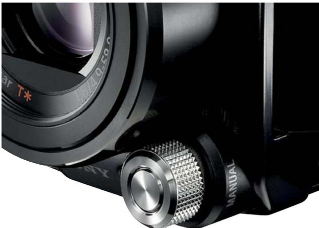
Abbildung 10-2 Drehregler eines Consumer-Camcorders
