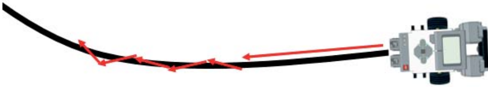
Abb. 5–2 // Linienverfolgung mit zwei Farbsensoren
