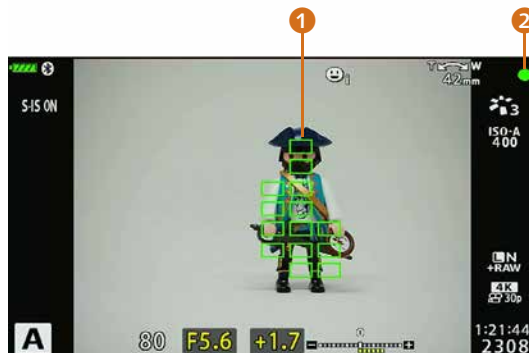
Abbildung 2.1: Die OM-D E-M10 Mark IV zeigt Ihnen auf dem Monitor die Scharfstellung an.
