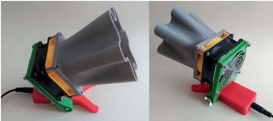
Bild 16.1 Kleiner Ventilator mit 80 mm Durchmesser
