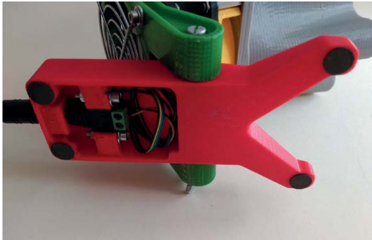
Bild 16.8 Filz pads an die Unterseite kleben
