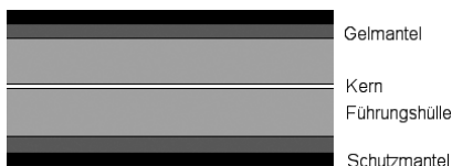
Bild 2.7 Der schematische Aufbau eines Lichtwellenleiters: Der Kern besteht aus dem das Licht leitenden Material. Er ist sehr dünn, mit dem bloßen Auge fast nicht zu sehen. Er wird von einer Kunststoffhülle gestützt. Diese ist von einem Gelmantel (oft aber auch ein Fadengeflecht) umgeben, der erlaubt, dass sich der Kern bewegen kann. Ganz außen ist eine Schutzhülle aus Kunststoff, die vor mechanischer Belastung schützt.
