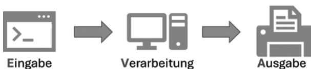
Bild 1.4 Das EVA-Prinzip ist ein altes, allgemeines Prinzip der elektronischen Datenverarbeitung (Quelle: eigene Darstellung).
