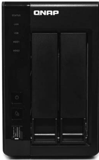
Abb. 1.1: Ein QNAP NAS mit zwei Festplatteneinschüben
