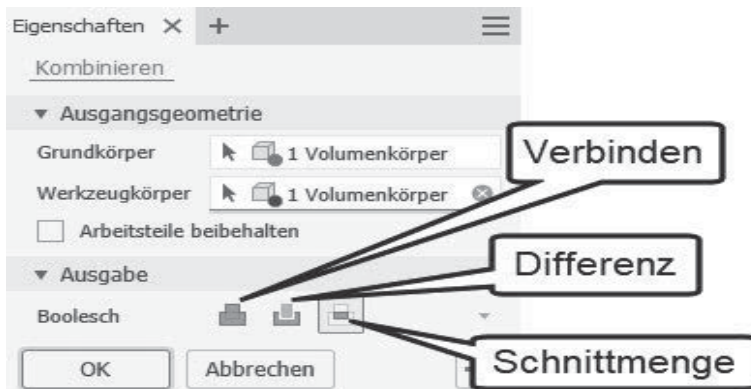
Abb. 1.21: Boolesche Operationen VEREINIGUNG, DIFFERENZ und SCHNITTMENGE
