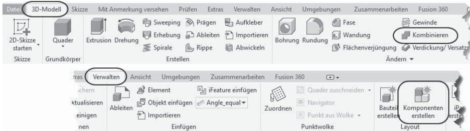
Abb. 1.24: Befehle KOMBINIEREN und KOMponentEN ERSTELLEN für Multipart-Konstruktionen
