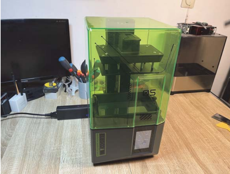
Abb. 1.1: Typischer Einsteiger-Resindrucker, hier in etwas gehobener Ausstattung: die Standard-Variante des beliebten Elegoo Mars 5
