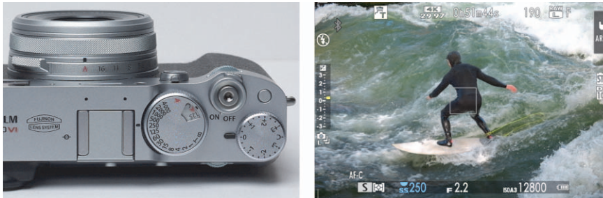
Abbildung 2.9 Links: Wenn Sie die Blende auf A und das Einstellrad für die Belichtungszeit auf einen anderen Wert als A stellen, interpretiert die X100VI dies als Zeitvorwahl. Rechts: Die Zeitvorwahl erkennen Sie am S links unten im Sucher oder auf dem Display.
