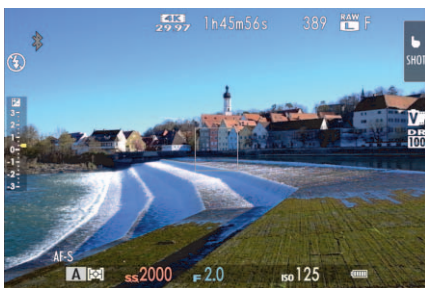
Abbildung 2.27 Wegen des Zentralverschlusses hängt die kürzeste Belichtungszeit (bis zum Blendenwert f5,6 ) von der eingestellten Blende ab. Im Beispiel wurde mit Blende f2 die kürzeste Belichtungszeit von 1/2000 s erreicht, weshalb der Wert in roter Farbe angezeigt wird.
