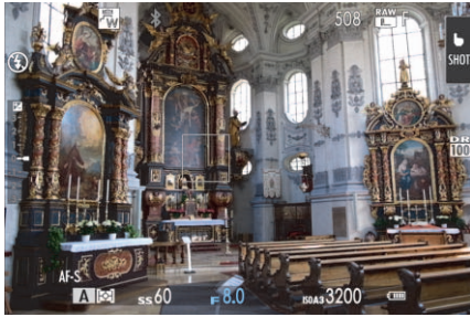
Abbildung 2.32 Ob und welche ISO-Automatik verwendet wird, erkennen Sie an den Angaben ISOA1 , ISOA2 oder ISOA3 (hier: ISOA3 ) links neben dem maximal möglichen ISO-Wert. Im Screenshot rechts unten.
