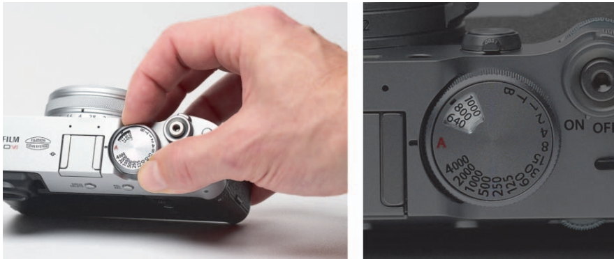
Abbildung 1.8 Links: Heben Sie das Einstellrad für die Belichtungszeit an, um den ISO-Wert anzupassen. Rechts: Dieser kleine ausgesparte Bereich am Einstellrad für die Belichtungszeit und den ISO-Wert zeigt den gewählten ISO-Wert an (hier: ISO 800).
