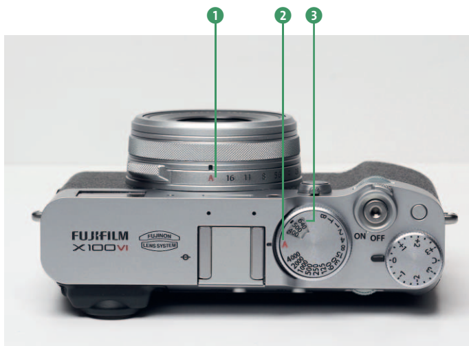
Abbildung 2.1 Die Programmautomatik aktivieren Sie, indem Sie die Einstellräder für die Belichtungszeit 2 und die Blende 1 auf A stellen. Beim ISO-Wert 3 habe ich mich für ISO 500 entschieden.
