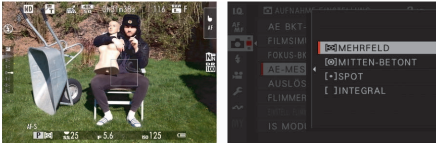
Abbildung 2.2 Links: Am Buchstaben P unten links erkennen Sie, dass Sie die Programmautomatik eingestellt haben. Die beiden anderen Werte der Belichtungszeit ( SS ; hier 25 ) und Blende ( F ; hier 5,6 ) werden in diesem Modus automatisch angepasst. Rechts: Die Einstellung für den Messmodus auf Mehrfeld zu setzen, ist in den meisten Fällen die beste Empfehlung für die Programmautomatik. (Model: Jonathan Wolf)
