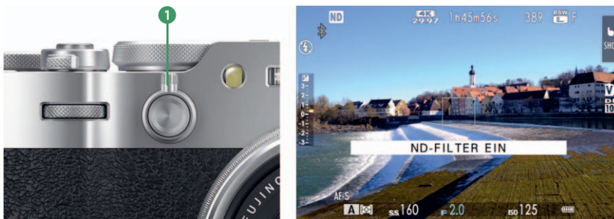
Abbildung 2.28 Halten Sie den kleinen Hebel 1 der Sucherauswahltaaste so lange nach rechts gezogen (von hinten betrachtet), bis der Text ND-Filter ein erscheint; der ND-Filter reduziert das einfallende Licht jetzt um 4 Blendenstufen. Links oben finden Sie das ND-Symbol, das anzeigt, dass der ND-Filter aktiviert wurde.
