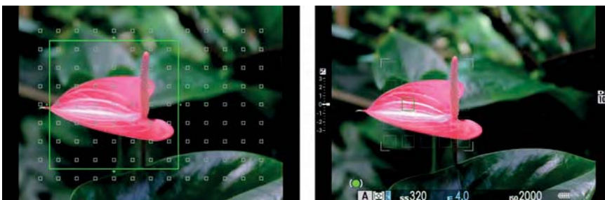
Abbildung 4.9 Links: Zuerst stellen Sie die Zonengröße mit dem hinteren Einstellrad ein (hier ein Zonenbereich von 5 x 5 Fokuspunkten). Rechts: Mithilfe von AF-C und dem Zonen-AF-Modus kümmert sich die Kamera nun um den zu fokussierenden Bereich innerhalb der Zone. Der Grund, warum ich den AF-Modus Zone und nicht den Einzelpunkt bei diesem Bild verwendet habe, war, dass es während der Aufnahme windig war und es viel schwieriger gewesen wäre, die Blume mit dem AF-Modus Einzelpunkt scharf zu stellen.
