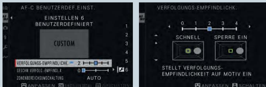
Abbildung 4.15 Wenn Sie bei den benutzerdefinierten Einstellungen einen Parameter mit der MENU/OK -Taste auswählen, sehen Sie eine animierte Grafik, die die Bedeutung des Parameters verdeutlichen soll. Im Beispiel sehen Sie die Verfolgungs-Empfindlichk.
