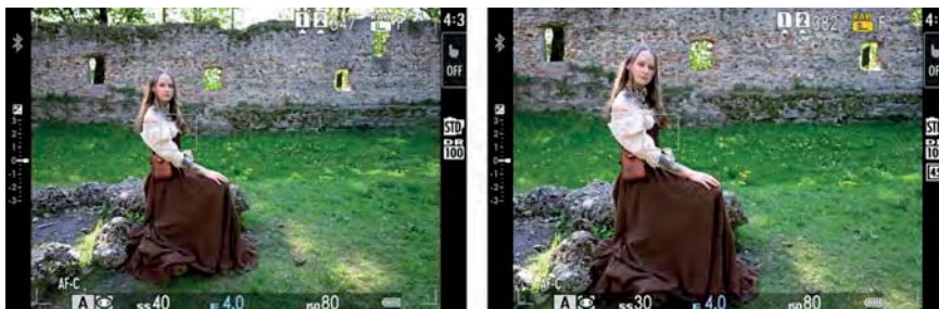
Abbildung 1.11 Der Bildausschnitt links ohne »Zoom« mit dem 35-mm-Objektiv (KB 28 mm). Man wünscht sich, etwas näher hineinzoomen zu können. Über den Crop-Zoom-Hebel wurde in der rechten Abbildung auf 45 mm (KB 36 mm) gecroppt, wie es im Display und Sucher auf der rechten Seite mit 45 angezeigt wird. (Model: Annika Fendt)
