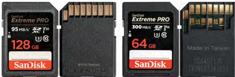
Abbildung 1.9 SDXC-Karten vom Typ UHS-I Speed Class 3, Video Class V30 (links) und UHS-II Speed Class 3, Video Class V90 (rechts)
