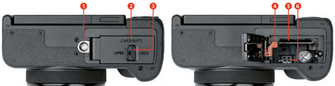
Abbildung 1.6 Die Unterseite der Canon PowerShot V1 mit geschlossenem (links) und geöffnetem (rechts) Akkufach
