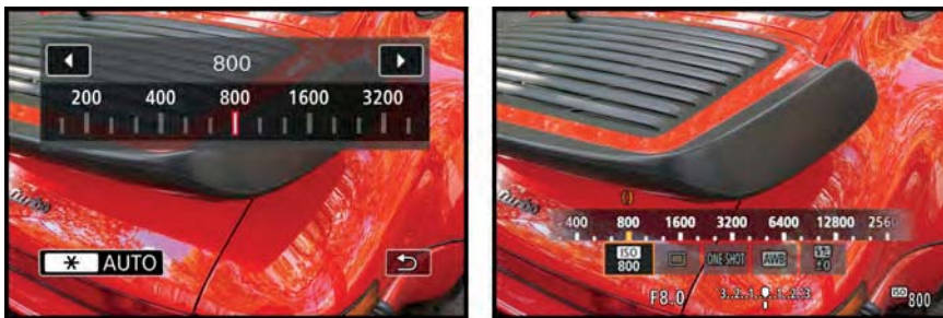
Abbildung 4.2 ISO-Einstellung über das Menü (links); den ISO-Wert mit der M-Fn -Taste und den Wahlrädern einstellen (rechts)
