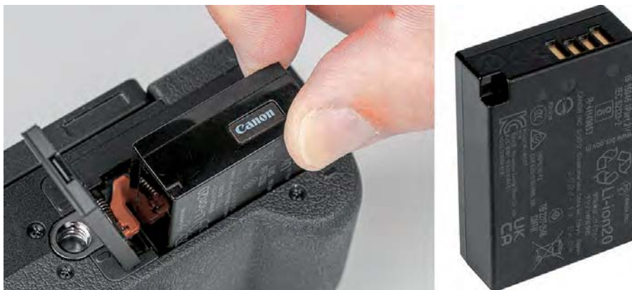
Abbildung 1.7 Links: Einlegen des Akkus; rechts: der Lithium-Ionen-Akku LP-E17 (7,2 V Nennspannung, 1.040 mAh Kapazität)
