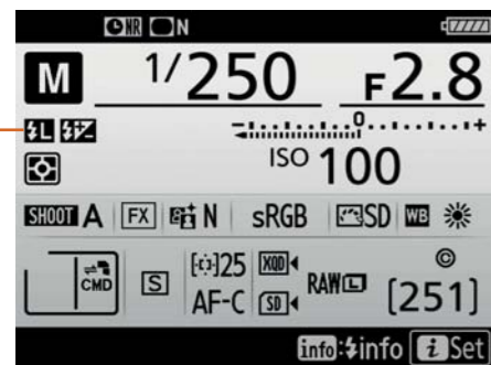
^ Abbildung 9.28 An dem L-Blitz-Symbol erkennen Sie, dass der Blitzbelichtungsspeicher aktiv ist.
