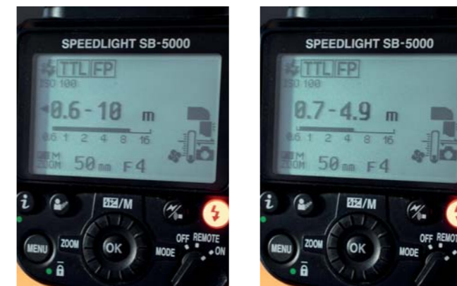
◀ Abbildung 9.3 Durch die FP-Kurzzeitsynchronisation wird die Blitzreichweite mindestens halbiert.
