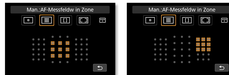
< Abbildung 5.10 Bei der AF-Messfeldwahl in Zone sind mehrere AF-Felder zusammengefasst. Auf dem Monitor und im Sucher lässt sich die AF-Zone in festen Bereichen verschieben.
