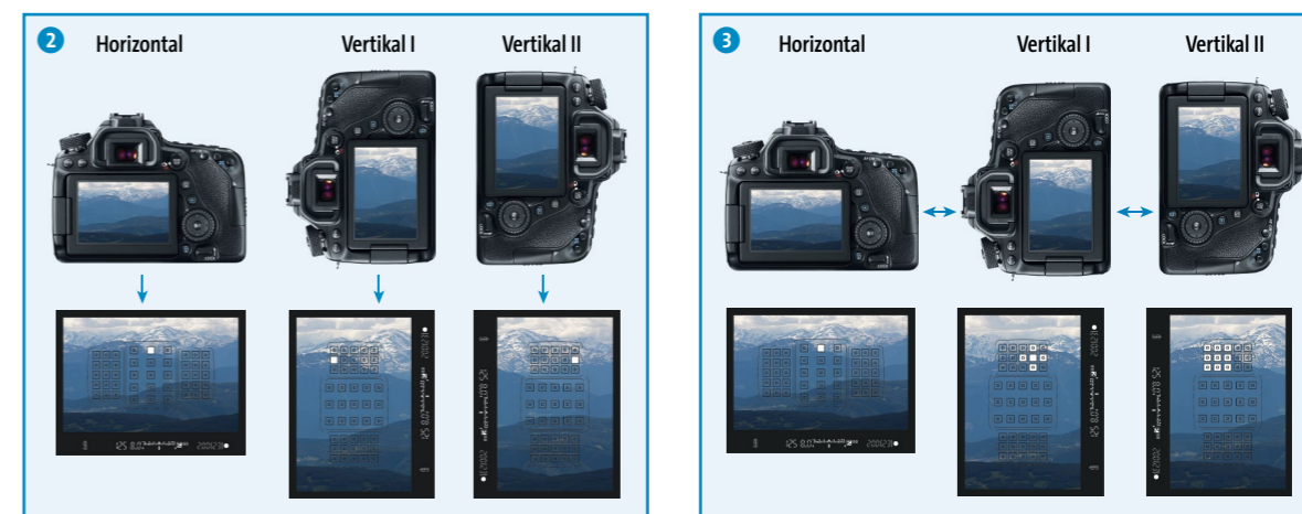
▼ Abbildung 5.17 Je nach Ausrichtung der Kamera und Einstellung unter AF-Messfeld Ausrichtung bleibt der AF-Bereichsmodus stets erhalten 2 oder wechselt je nach Ausrichtung 3 .
