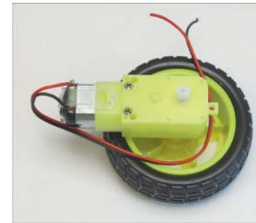
Abbildung 7.8 Elektromotor mit angelöteten Stromkabeln
