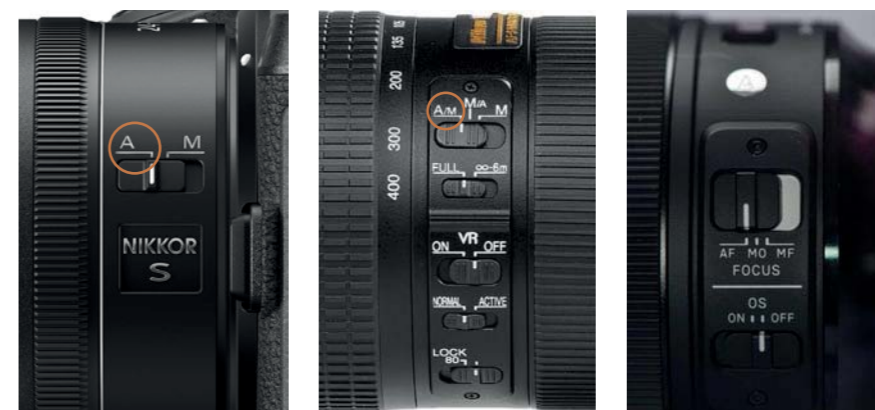
Abbildung 3.18 Um den Autofokus zu aktivieren, müssen Sie den Fokussierschalter am Objektiv auf A (links, Bild: Nikon) beziehungsweise A/M stellen (Mitte, Bild: Nikon). Bei Objektiven von Fremdherstellern lauten die Kürzel meist AF und M beziehungsweise MF und MO (manual overwrite, rechts).
