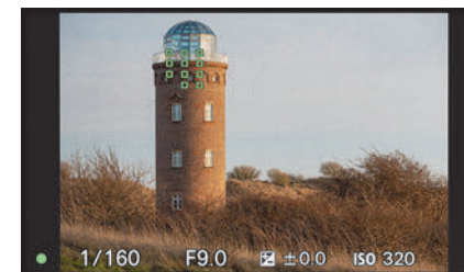
Abbildung 5.1 Bei erfolgreicher Scharfstellung leuchten die aktiven Fokussierrahmen sowie der Fokusindikator (unten links) durchgehend grün, und es ist ein Signalton zu hören.
