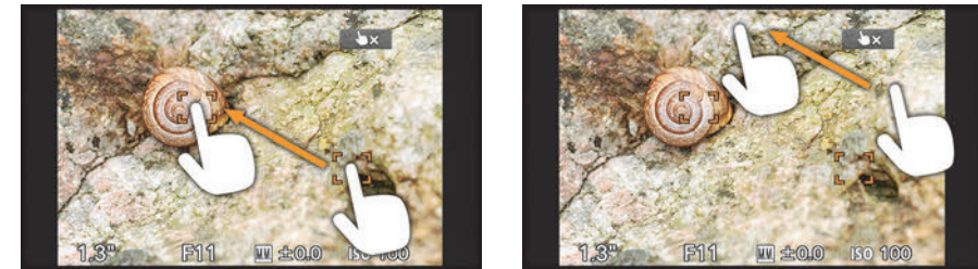
Abbildung 5.11 Verschieben des Fokussierrahmens durch Ziehen des Fingers über den Monitor, einmal mit Absoluter Position (links) und einmal mit Relativer Position (rechts)
