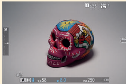
Abbildung 3.9 Wenn Sie den Auslöser halb herunterdrücken oder die AE-L-Taste verwenden, wird eine gespeicherte Belichtung verwendet, wie es am blauen EL-Symbol neben dem Symbol für Belichtungsmessmethode zu erkennen ist.
