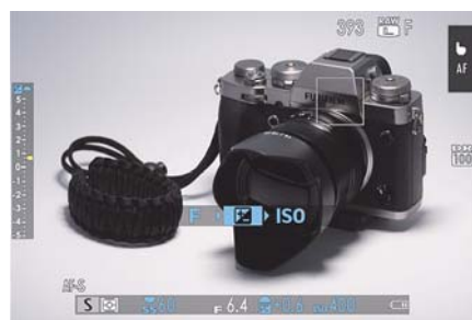
Abbildung 3.19 Bei der Stellung C des Belichtungskorrekturrades können Sie durch Drücken des vorderen Einstellrades zwischen der Einstellung des ISO-Werts, der Blende (bei XC-Objektiven) und der Belichtungskorrektur wechseln.
