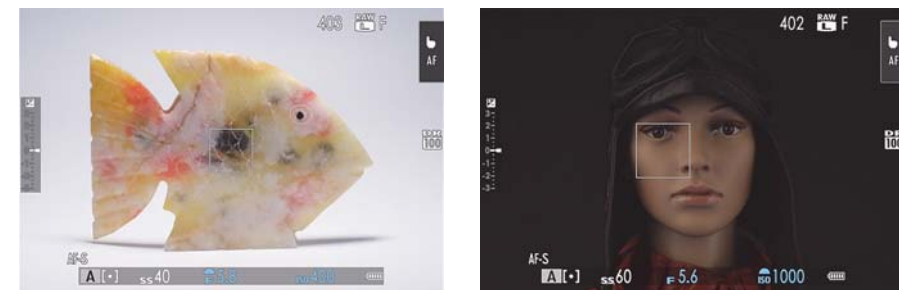
Abbildung 3.6 Die Beispiele zeigen deutlich, dass sich die Spotmessung nur auf den Fokusserrahmen konzentriert bzw. einen Teil davon. Der Bereich um den Fisch herum ist viel heller, beim Mannequin wird das Gesicht deutlich hervorgehoben und der Bereich darum abgedunkelt.
